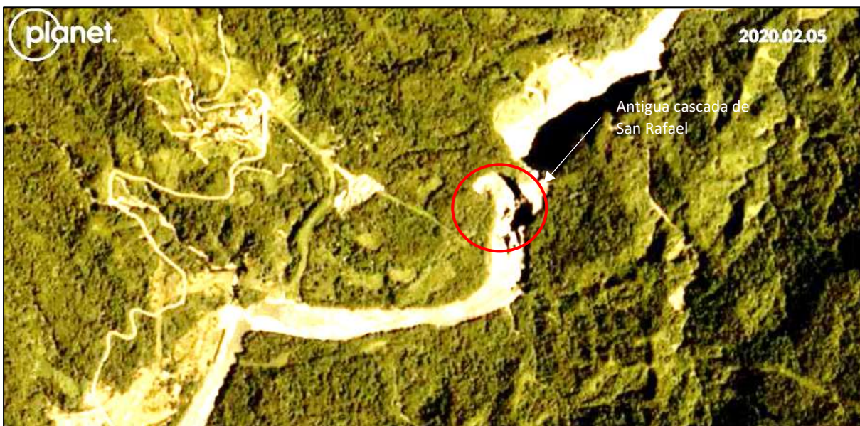
Foto 4 Colapso total de la dolina o chimenea. La intercepción entre la pared derecha de la dolina (por incremento del volumen de materiales desplomado desde ésta) con el río, produjo el desvío de sus aguas con ingreso de las mismas por la chimenea, generando un proceso acelerado de erosión regresiva y un gran deslizamiento de los taludes circundantes y pérdida de la cascada el 2020 02 04 con formación de un puente natural. La chimenea de forma cónica, de un diámetro de D = 100\text{m} en superficie y una altura hasta la base del río de H = 130\text{m} desplazó un volumen aproximado de V = 340.000\text{ m}^3 a los cuales se debe añadir el volumen de los materiales deslizados ubicados sobre el borde de la chimenea (estimados en V = 100.000\text{m}^3 ) es decir; el V total aproximado pudo ser de V_t = 440.000\text{ m}^3 . Luego del 2020 02 04 el río Coca tomó curso por debajo de la antigua cascada y desplazó aguas abajo todos los materiales desplomados de la chimenea y de la ladera deslizada. La capacidad de transporte del río entre el 2019 10 04 hasta el 2020 02 05 (121 días) se estima en C \geq 3600\text{ m}^3 / \text{día} . Escala aproximada E = 1/20 . Fuente de la imagen: www. Planet.com/stories
