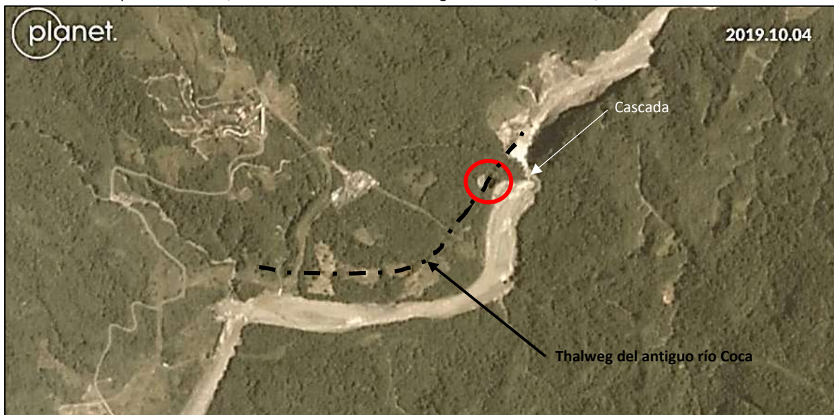
Foto 2 En la imagen satelital se indica en el centro del círculo rojo una dolina o chimenea, la cual pudo haber sido formada el 02 o 03 de octubre / 2019 pocos días antes de la fecha de la imagen. Dista de la zona de la cascada una L \approx 150\text{m}
