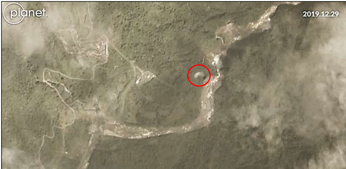
Foto 3 El 2019 12 29 se observa una ampliación del volumen de la dolina o chimenea que a la fecha tuvo un diámetro medio aproximado de 80m. Nótese que le río Coca mantiene su curso sin desviar sus aguas hacia la dolina. Escala aproximada E = 1/20.000 . Fuente de la imagen: www. Planet.com/stories
