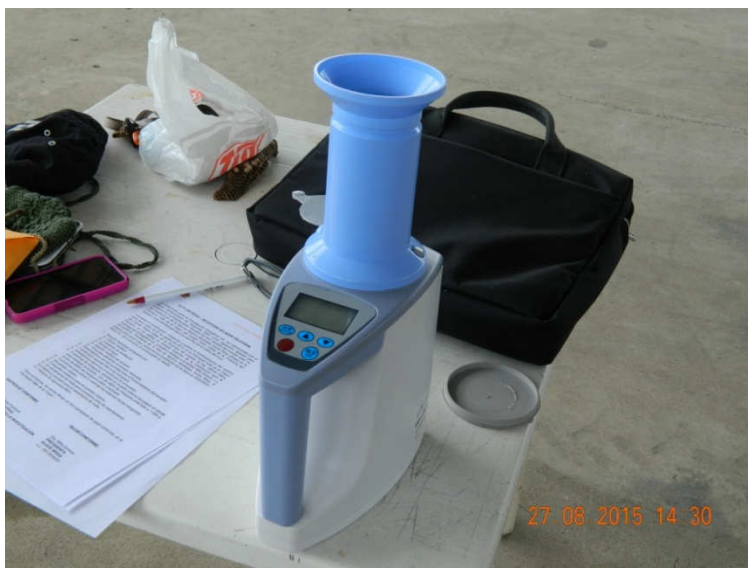
Aparato para medir la humedad del grano tanto a la entrada como a la salida del sistema.
